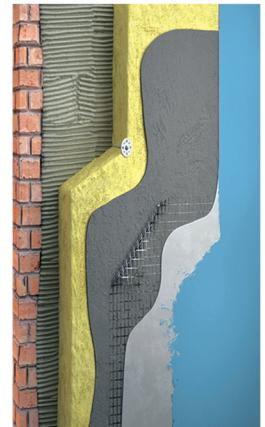
نمای عایق حرارتی سیستمی مت Shank از پانل‌های پلی‌استایرن فشرده، مش فایبر گلاس و لایه‌های اندود پلی‌مری است که با زنگ نما پوشش داده می‌شود. این سیستم با وزن سبک خود بار سازه را کاهش داده، ضمن جلوگیری از اتلاف انرژی، عایق صوتی مناسبی نیز محسوب می‌شود. مقاومت در برابر رطوبت، ترک خوردگی و اشتغال از دیگر مزایای این نماست که آن را به گزینه‌ای اقتصادی و کارآمد تبدیل کرده است.
